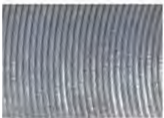
N9 R_a 6,3 \mu\text{m} – AARH / CLA 250 R_z 25,7 \mu\text{m}
