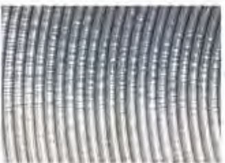
N10 R_a 12,5 \mu\text{m} – AARH / CLA 500 R_z 48,7 \mu\text{m}
