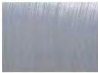
N6 R_a 0,8 \mu\text{m} – AARH / CLA 32 R_z 3,20 \mu\text{m}
