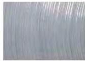
N8 R_a 3,2 \mu\text{m} – AARH / CLA 125 R_z 12,5 \mu\text{m}
